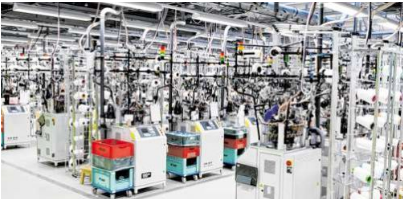
Bei Juzo in Aichach (oben) arbeiten rund tausend Mitarbeiter. Das Stricken der Kompressionsstrümpfe übernehmen Maschinen (unten). Doch viele Arbeitsschritte bei Juzo müssen per Hand erledigt werden. Fotos: Juzo
